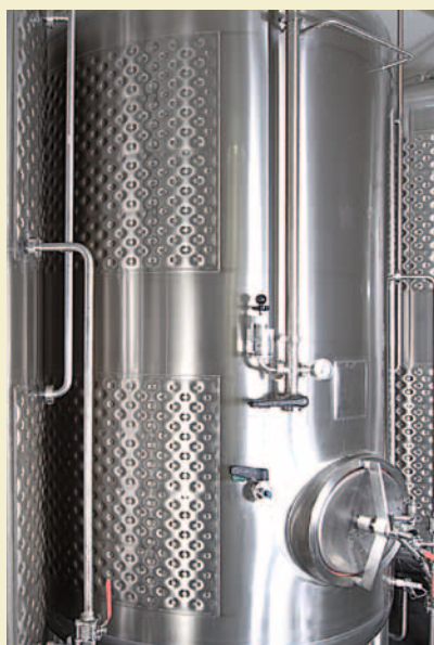
Im zukünftigen Hefe-, Gär- und Lagerkeller trifft man auf Behälter mit spezieller Oberflächenveredelung, die aufgeschweißte Kühltemplates aufweist
